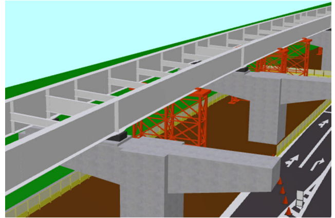
図 1 詳細度 200 モデル例 (2 主鋼桁の架設状況)
