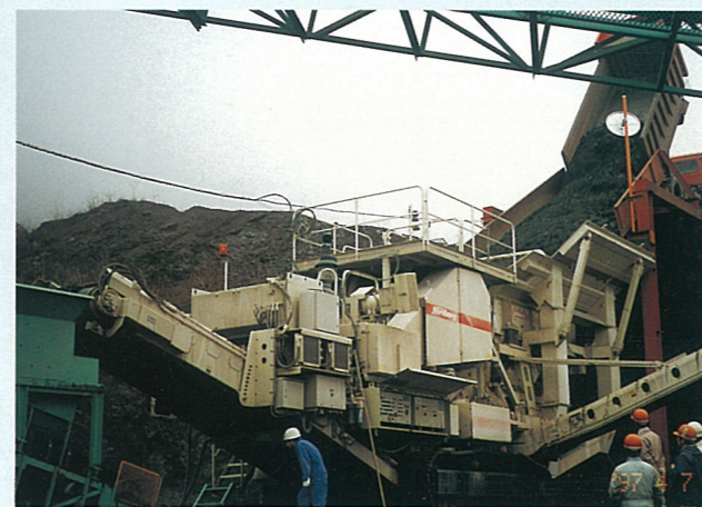
LT125. ホイールローダとダンプカーによる投入 (西武建材株式会社)。
