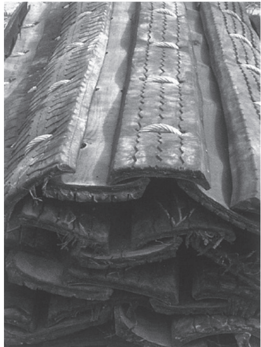
写真3 一般的な発破マットの重量は、1m 2 当たり60kgです。
