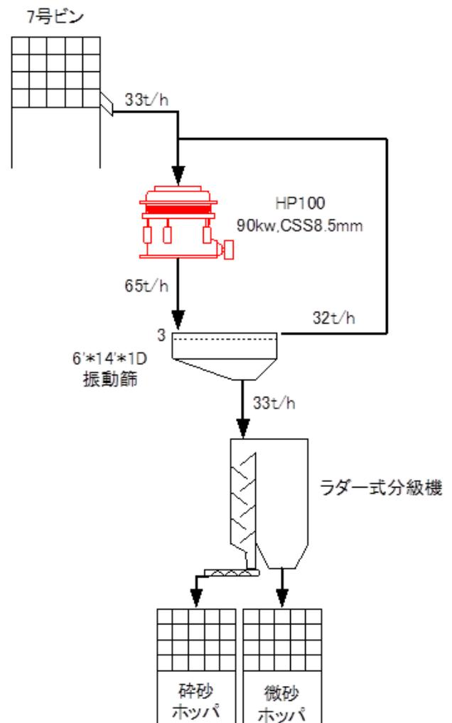
図4 HP 碎砂閉回路システム
