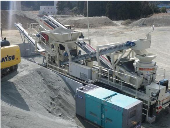
写真4 移動式砕砂製造設備NW100HP
