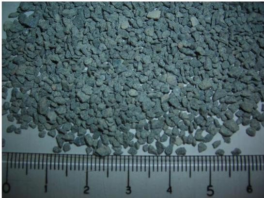
写真1 No. 1 製品粒形(2.5-1.2mm)
