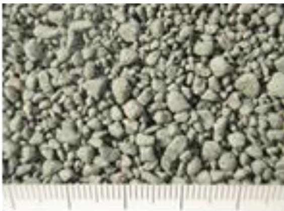
写真2 No. 2 製品粒形(2.5-1.2mm)
