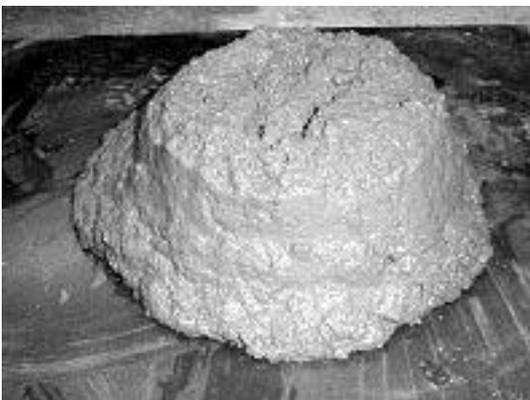
写真5 砕砂100%生コン練試験
