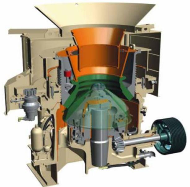
図2 HPコーンクラッシャ構造断面
