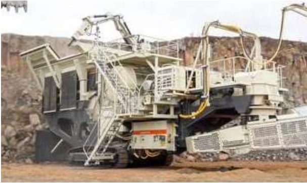
写真-⑤ LT150E 移動式破碎機 (電動 M)
