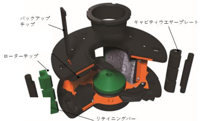
図2 オレンジローター全体構造図
