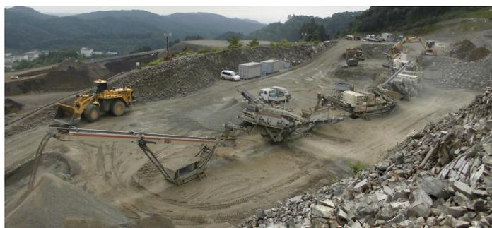
図 - 8 B 社で稼働中の移動式破碎機
