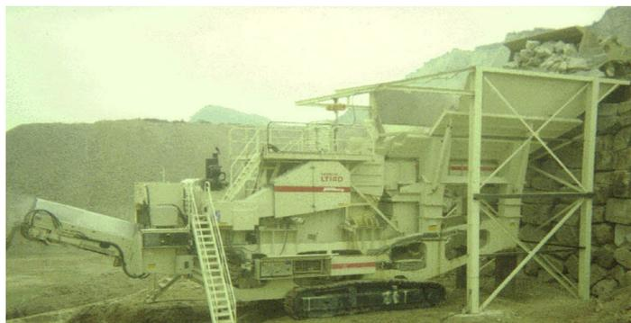
図-17 ダンプ直投入型 LT 用ホッパー（例）
