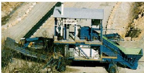
図 - 1 1985年以前の移動式破碎機例
