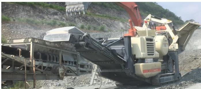
図一5 電動式破碎機
