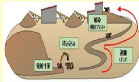
図3 従来工法 (ダンプ+固定式破砕機)
