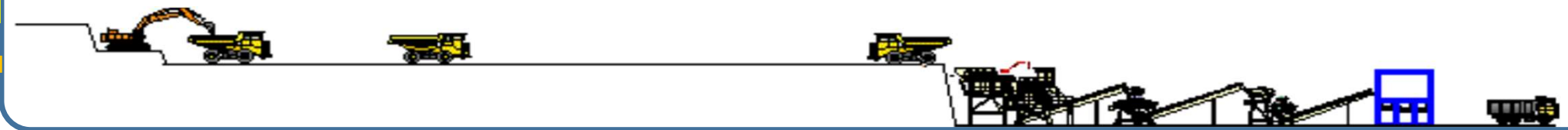
【移動式破碎機+コンベヤ】（ダンプと重機大幅削減） Case-1
