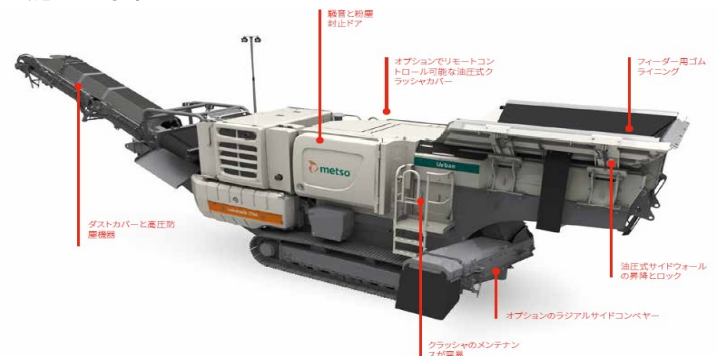
図3 ロコトラック Urban 型の機器名称と機能
