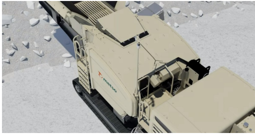
図6 破碎機防音、発塵防止カバー（閉じた状態）
