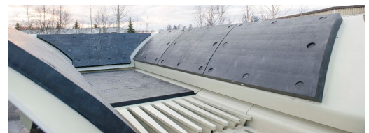
図4 フィーダ部のゴムライニング（原石投入時の騒音を低減）
