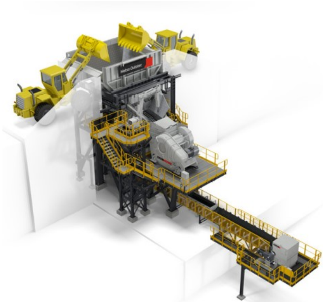
図7 ジョークラッシュステーション(ローダー投入、複数台)
