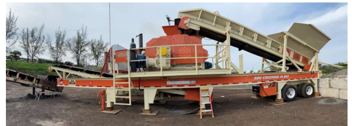
写真1 HPGR トレーラー搭載型
