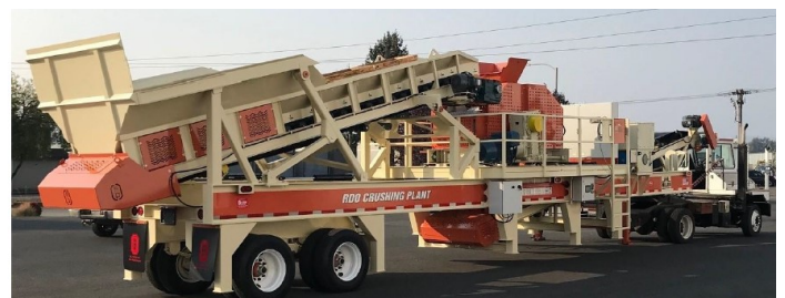
図8 移動式 HPGR8 搭載機写真
