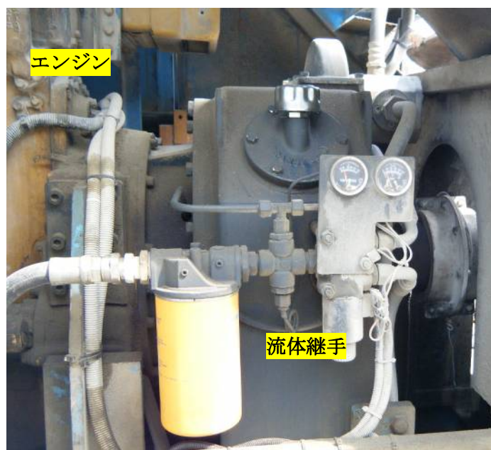
写真4 エンジン、流体継手で稼働する破碎機
