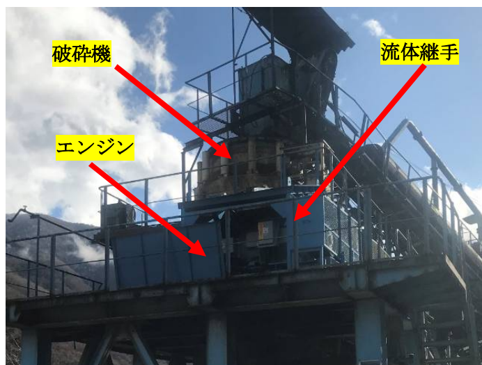
写真4 エンジン、流体継手で稼働する破碎機
