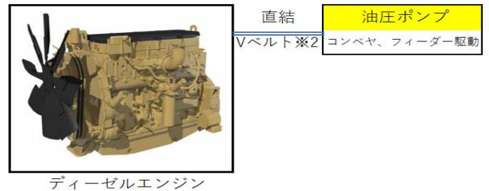
図 2 現在 Metso 移動式破碎機駆動系モデル図 (※2) 油圧ポンプからの油圧源により油圧モータ、V ベルトを介して破碎機を駆動させる。
