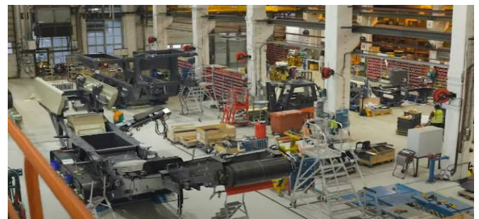
写真 3 工場内で組立中の破碎機写真
