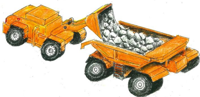
図 20 無人重機による無人ダンプへの積み込み
