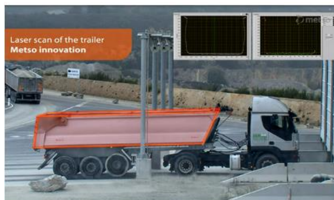
図14 自動出荷装置外観（ダンプ計測）
