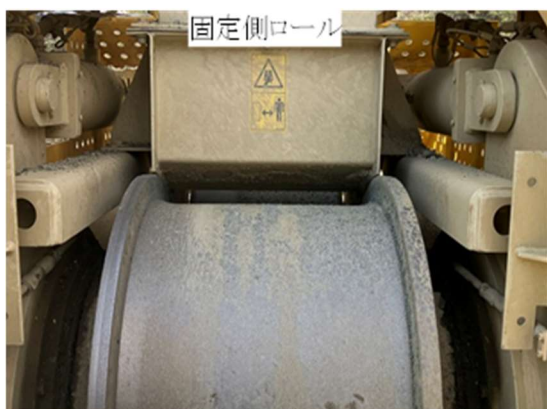
写真4. 固定側ロール摩耗状況（1800 時間経過後）
