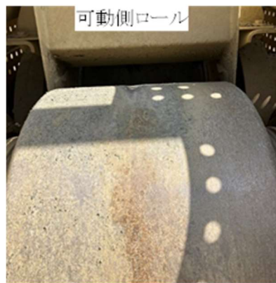
写真5. 可動側ロール摩耗状況（1800 時間経過後）
