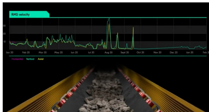
図11 遠隔監視ローラ制御画面（例）
