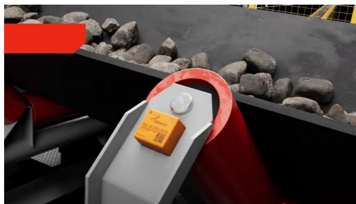
図10 遠隔監視ローラ外観図（黄色の部分に監視用ピックが内蔵されている。）
