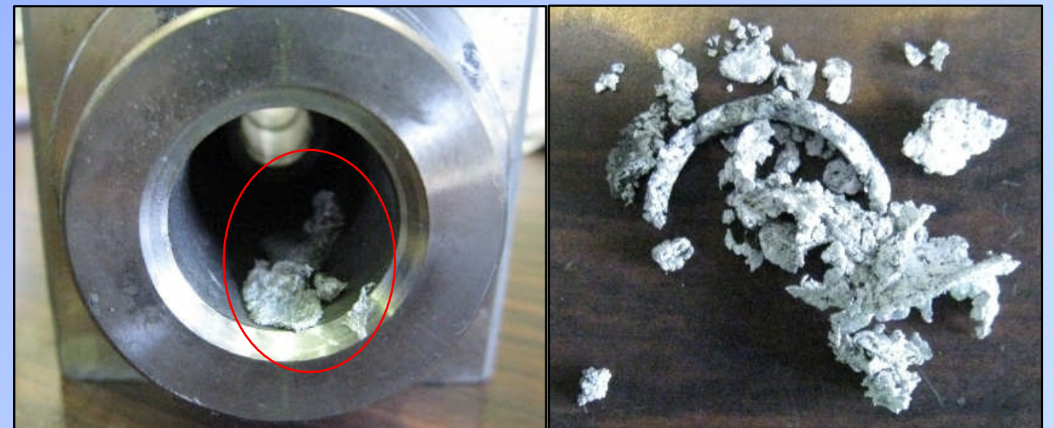
GFバルブ内へ進入したアルミ片
