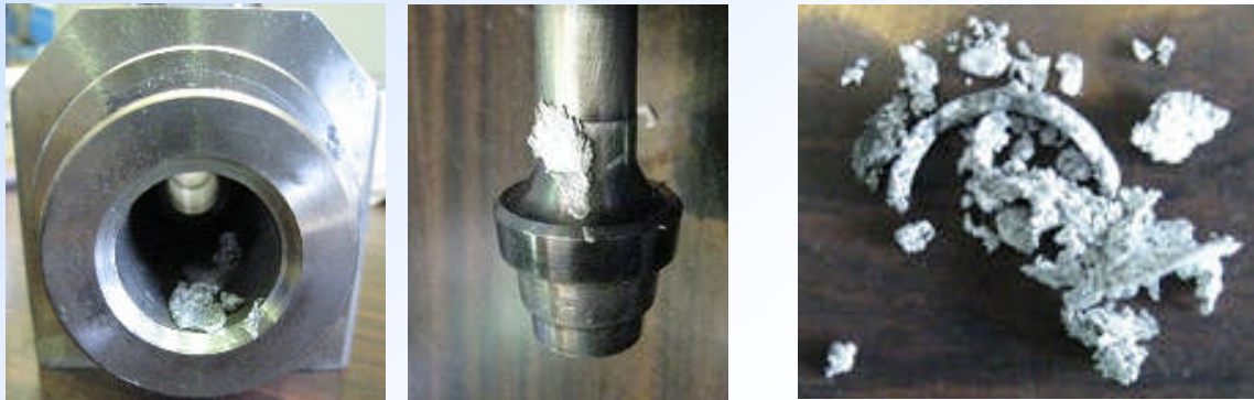
バルブ内へ進入したアルミ
