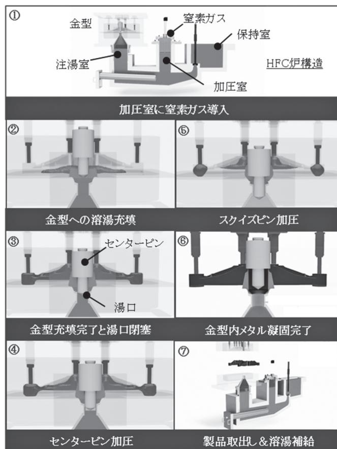
図3 HFC の鑄造工程
