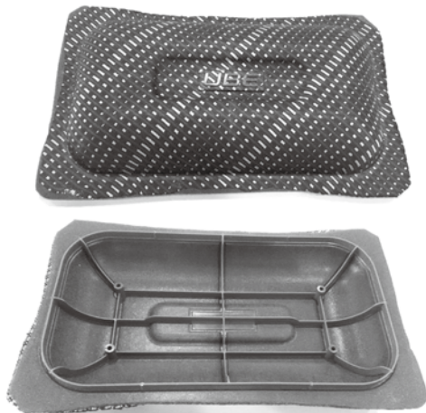
図3 ハイブリット射出成形事例①
