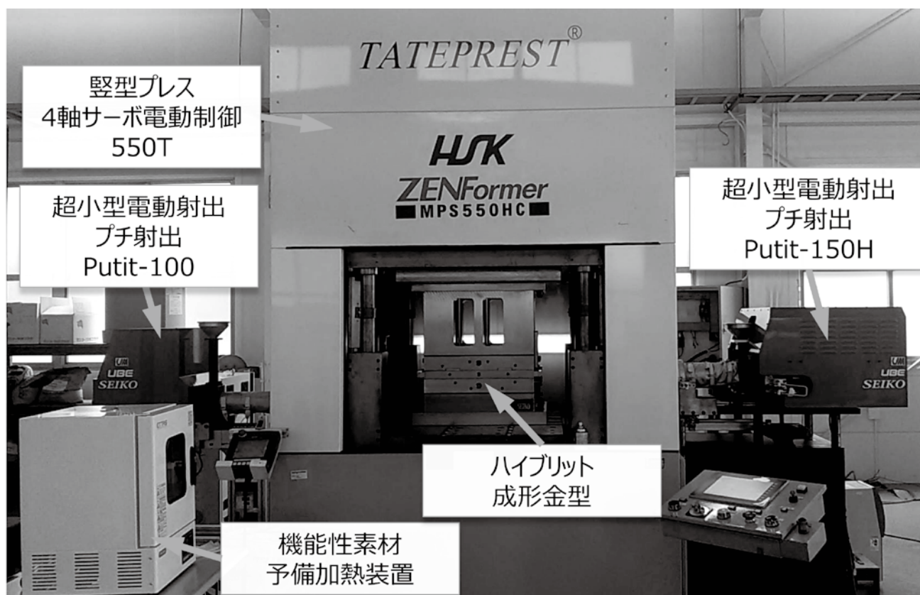
図2 TATEPRESTハイブリット射出成形システム
