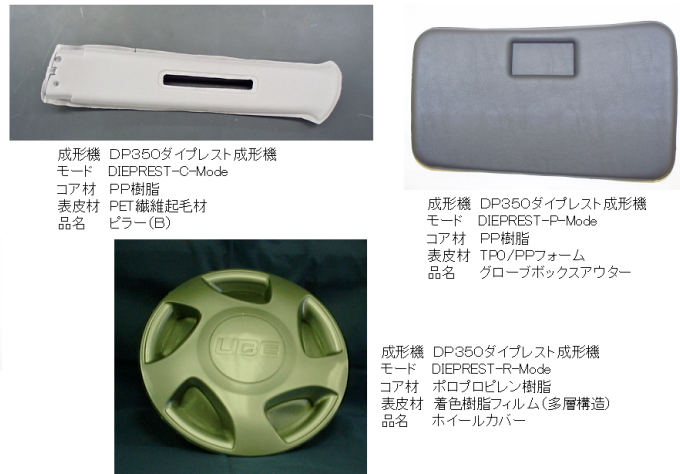
写真2 ダイプレスト成形事例(C-Mode、P-Mode、R-Mode)
