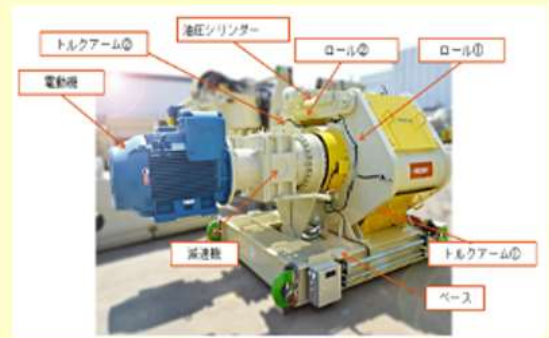
図3 HPGR外観写真
