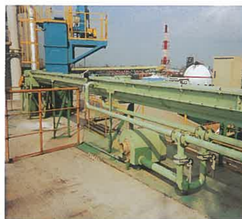
40t/h エア浮上コンベヤ (トラフ式) 40t/h Air Floating Conveyor (trough type)
