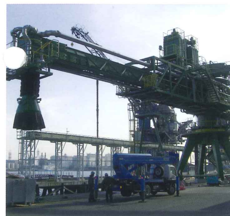
砕砂・石灰石船積用 能力 2000t/h
