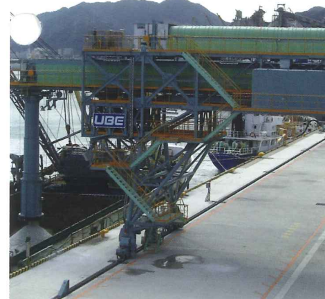
砕砂・石灰石船積用 能力 2000t/h
