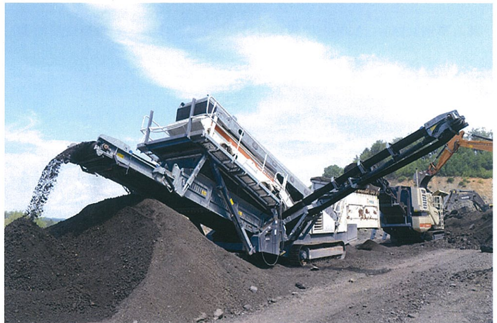
「導入事例」LT96+ST272の組み合わせによる、-40、+40 生産設備(能力300t/H)
