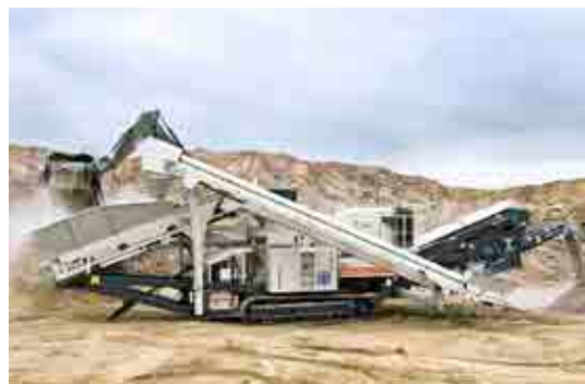
ロコトラック® LT200HPS™ - 1段または2段の取外し可能なクリーンを装備できる
