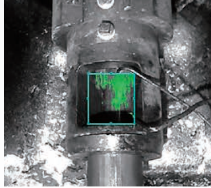
注湯口のアルミ付着検知例
