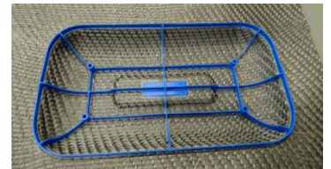
裏面射出 + 染出射出成形 (プチ射出にて成形)
