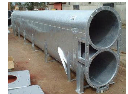
写真5: 例②コンベヤフレーム断面
